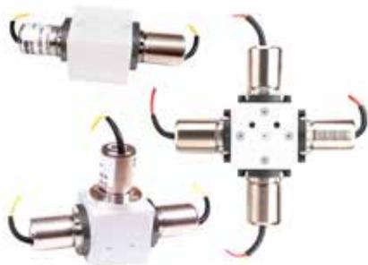
系列 18 设计可实现多液体系统中的紧凑安装。系列 18 具有多个进气口和一个出气口（或多个输出一个输入），沾湿部件均为 Teflon®。不用在各个阀门之间进行管道连接和电气连接，减少了死体积。重复性和快速响应时间使得系列 18 非常适用于控制较小百分比的低流速液体。
